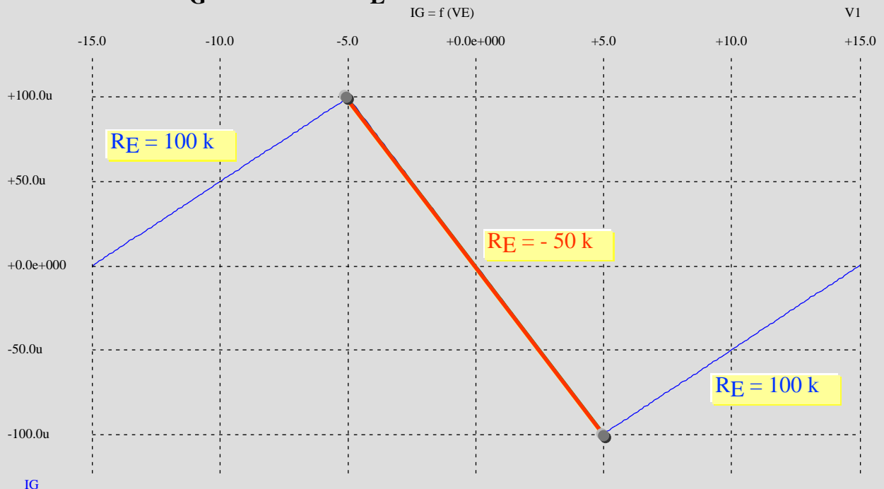
Courant d'entrée I_G en fonction de V_E
